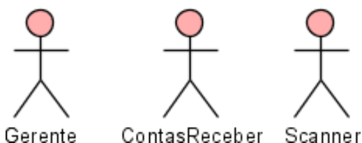
Figura 12: Notação UML para ator.
