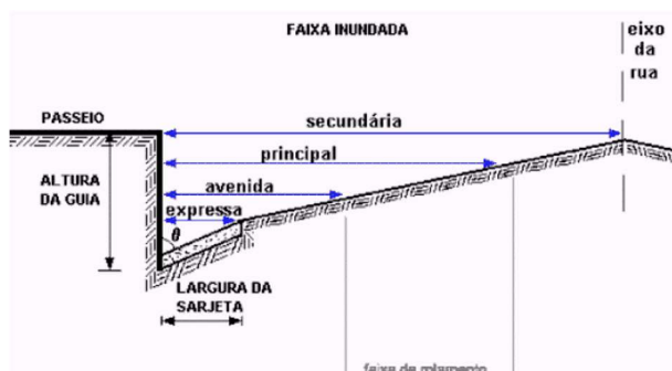
Figura 45 - Tipo de cobrimento das lâminas d'água
