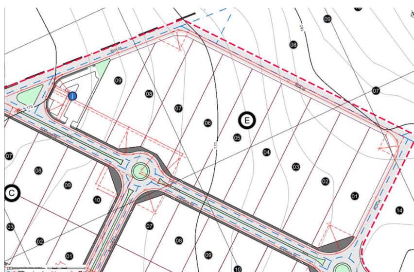
Figura 21 - Ampliação que apresenta rotatórias e ilhas de separação de fluxos.
