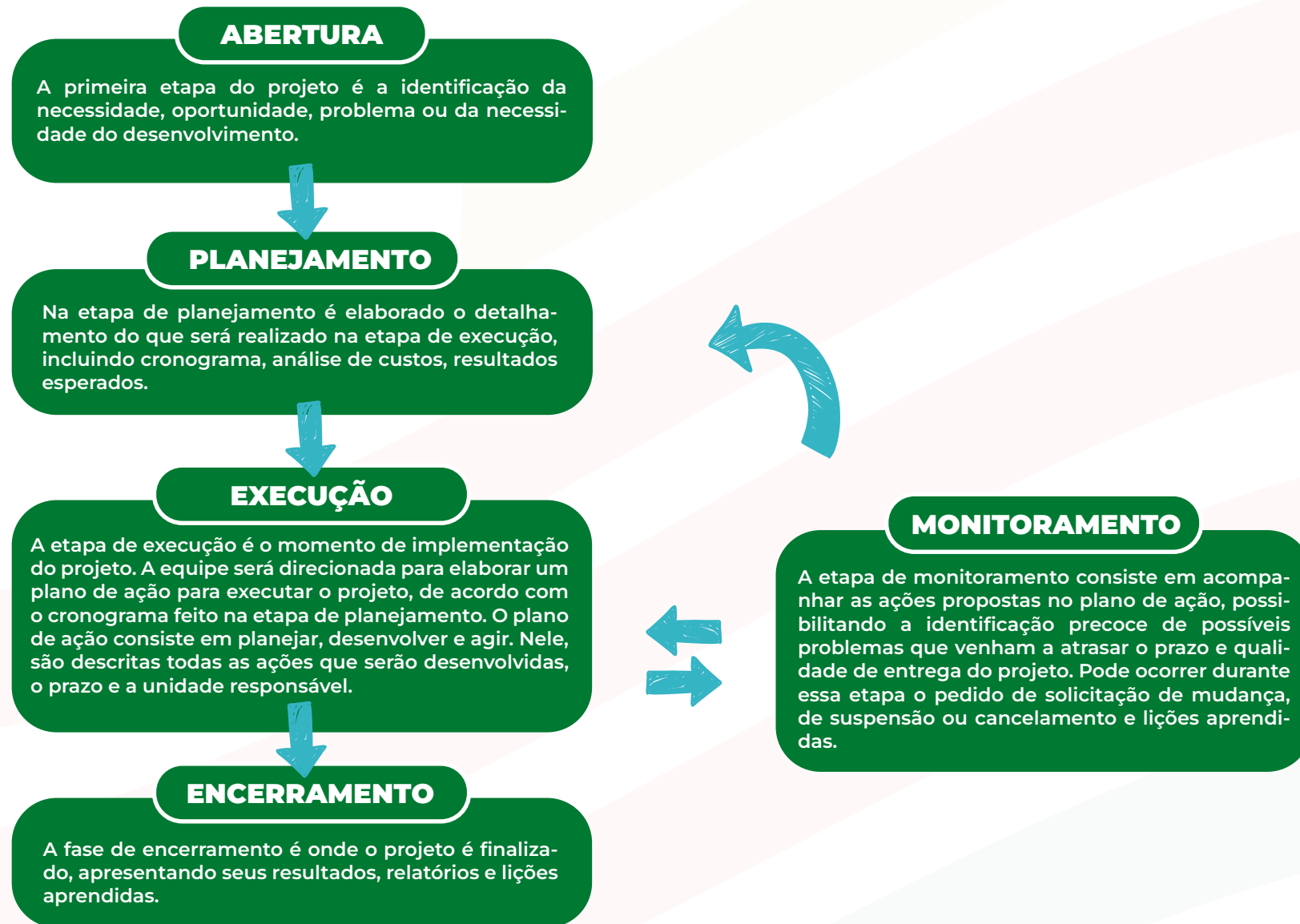
Figura 5 - Ciclo de vida do projeto baseado no modelo tradicional de gestão de projetos
